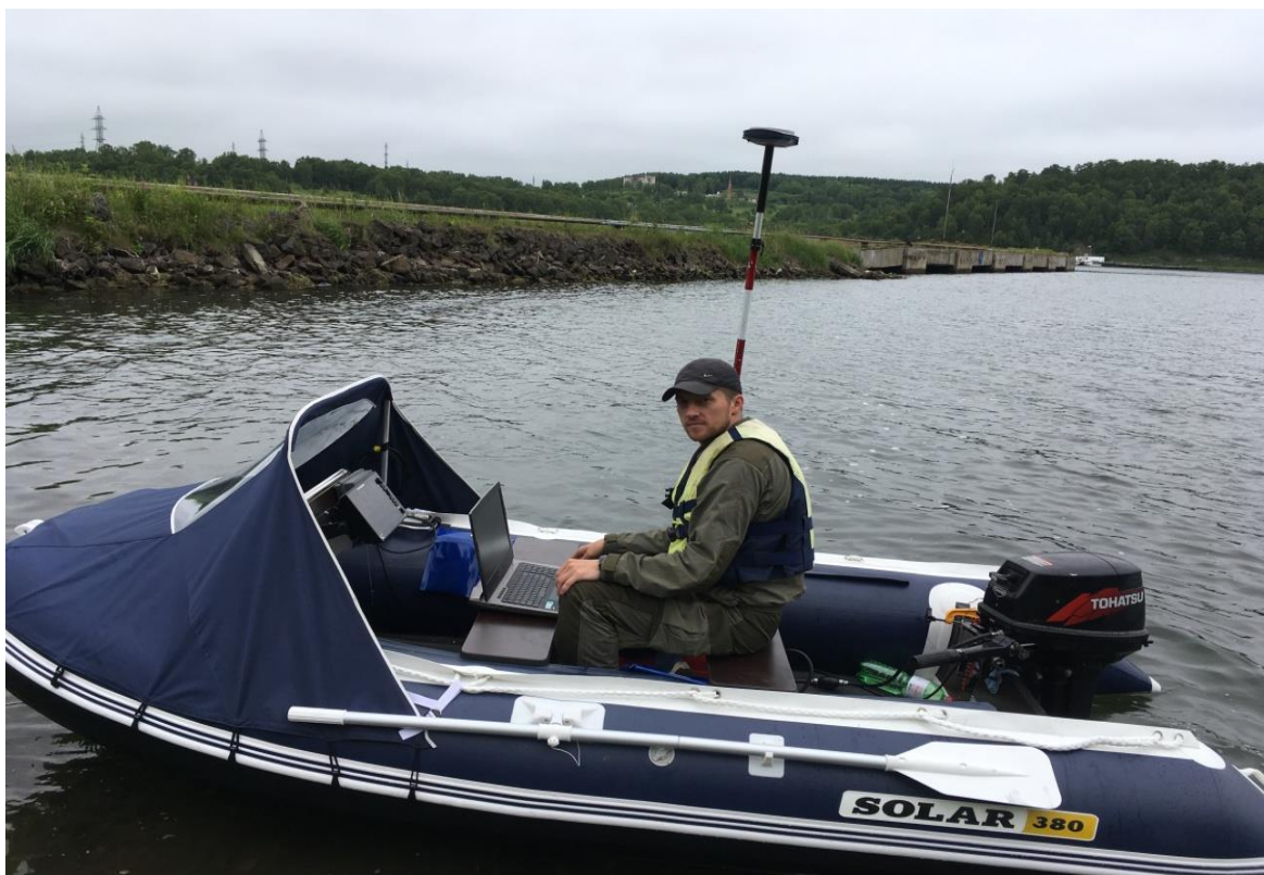
Промер глубин подхода, к причальному сооружению, со стороны имеющих судовых фарватеров, на предмет возможности приема на объекте морских судов различной грузоподъемности по адресу: Хабаровский край, Советско-Гаванский район
