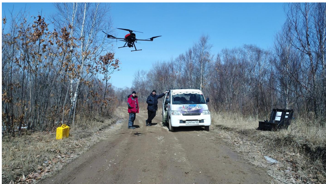
Аэрофотосъемочные работы масштаба 1:1000 для подсчета объемов вскрышных работ
